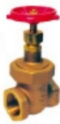
Válvula de compuerta cabeza roscada, vástago ascendente, cierre de bronce a bronce, cuña solda. 125 Lbs./Pulg2 S.W.P. 200 Lbs./Pulg2 W.O.G. Fig. 82 Extremos roscables, medidas 1/4" a 2". Fig. 782 Extremos soldables, medidas 1/2" a 2".
