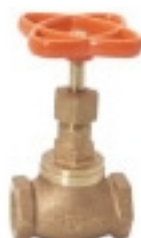
Válvula de globo cabeza roscada vástago ascendente, cierre de bronce a bronce, de 1/4" a 1/2" disco integral, disco giratorio de 3/4 en adelante extremos roscables, 125 Lbs./Pulg2 S.W.P. 200 Lbs./Pulg2 W.O.G. Medidas 1/4" a 4".
